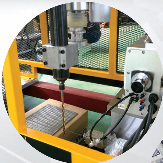
スカラロボットによる ドリルでの自動穴あけ加工
