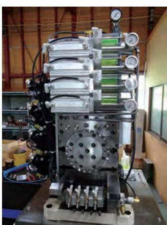
油空圧変換装置
