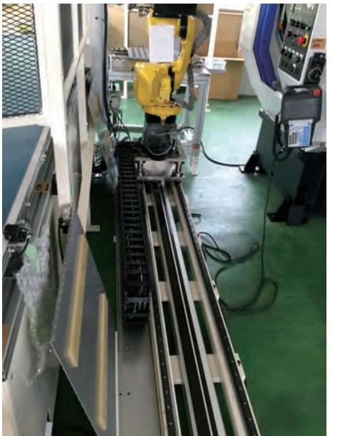
自社製ロボット走行レール
