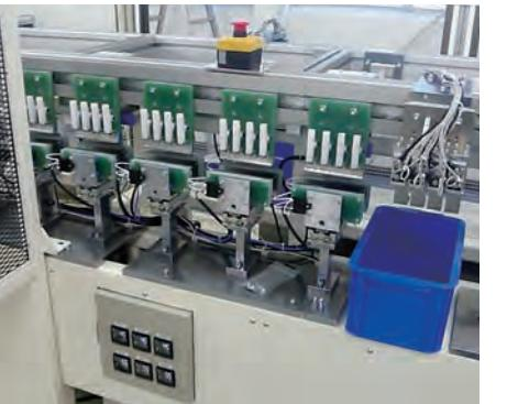
自動車部品の自動温度動作試験装置
